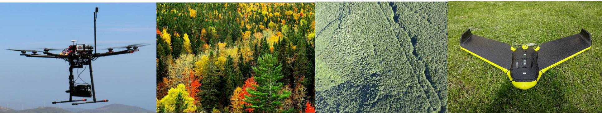
Tramite l'utilizzo di **droni** equipaggiati con sensori **LiDAR e ottici** verranno acquisiti dati ad **alta risoluzione** con i quali si procederà a verificare l'operatività di **metodi automatici e semiautomatici di mappatura di variabili forestali** utili a caratterizzare la fisionomia e le condizioni dei popolamenti forestali alla scala operativa tipica della gestione forestale
