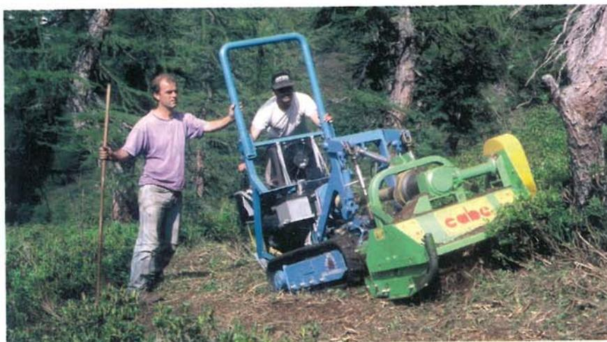
**Foto 3** - La macchina motrice dotata di trinciatutto, impegnata nelle operazioni di taglio del rododendro (foto Luca Rotelli).
