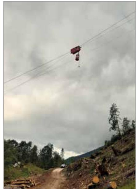
**Foto 3** - Segnalazione di una linea di gru a cavo secondo la Normativa (foto: RUGGERO ALBERTI - APROFOD).
